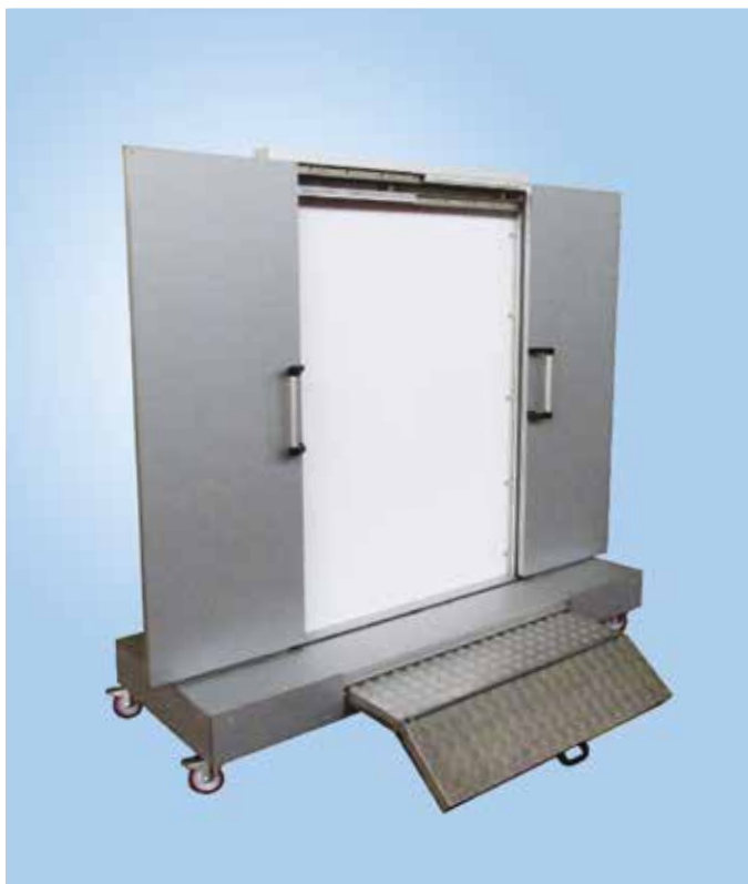
Simulatore prova apertura porte per treno
