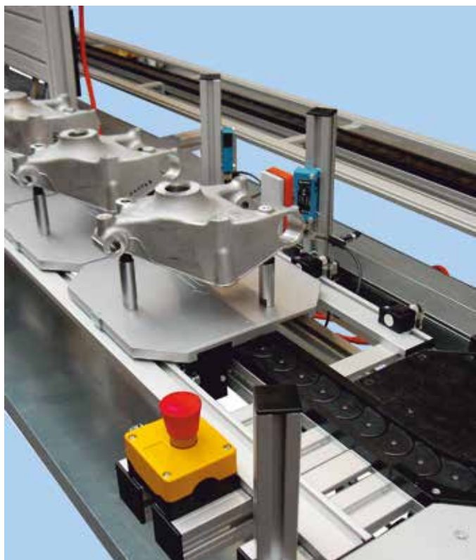
Convogliatore plate chain con pallet e componenti da lavorare
