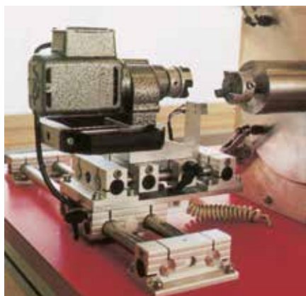
Azionamento accoppiabile e disaccoppiabile su unità di traslazione X/Y per tamburo per microrivestimento. Motore elettrico in posizione disaccoppiata.
