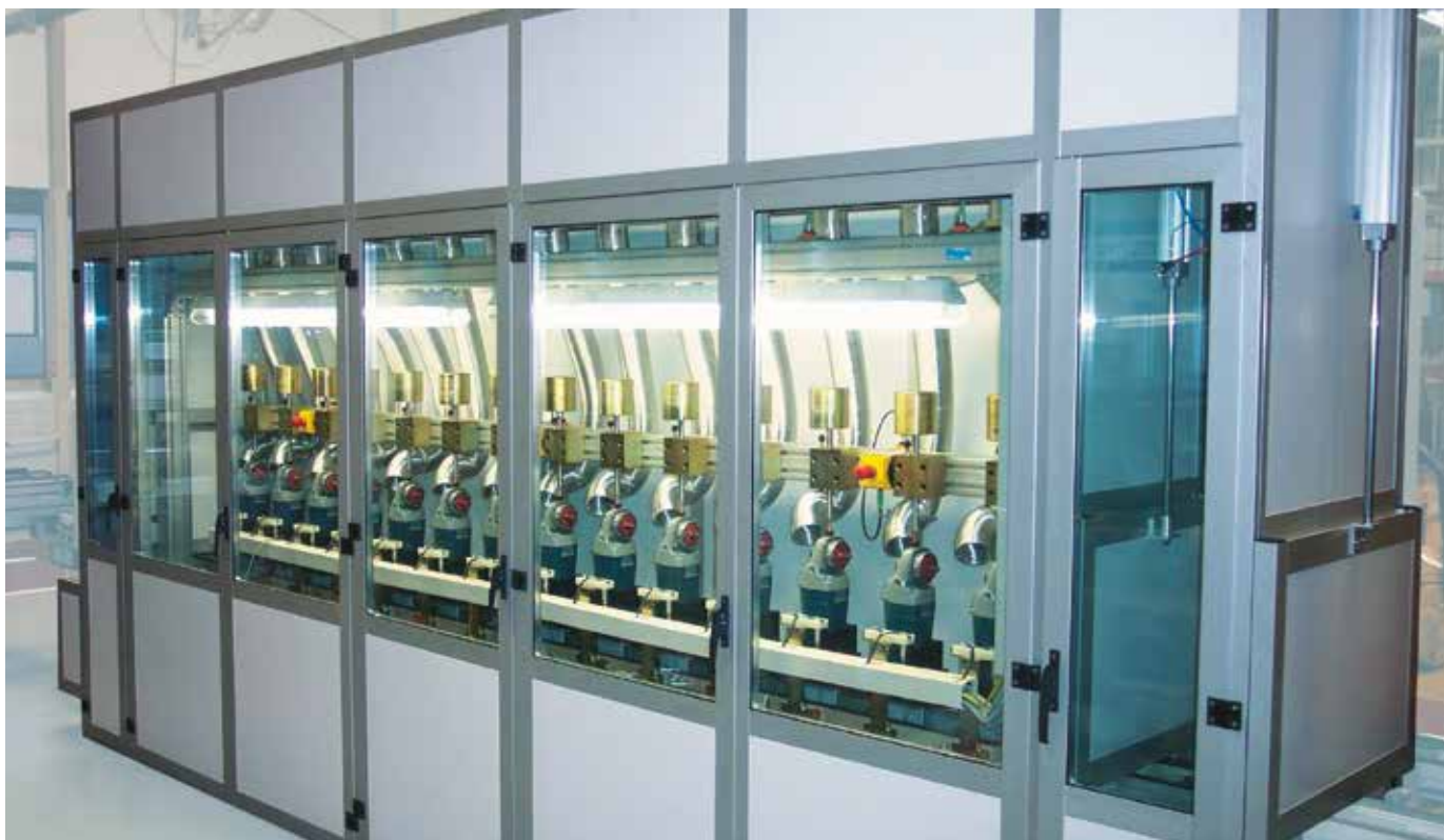
Banco di prova per test a fatica per rettificatrice angolare, con intercapedine anti-rumore
