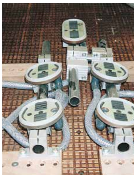
Aspiratore adattabile per la lavorazione di diversi tipi di schienali per sedia.
