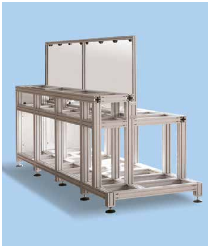
Stazione di prove dei telai al carbonio per biciclette
