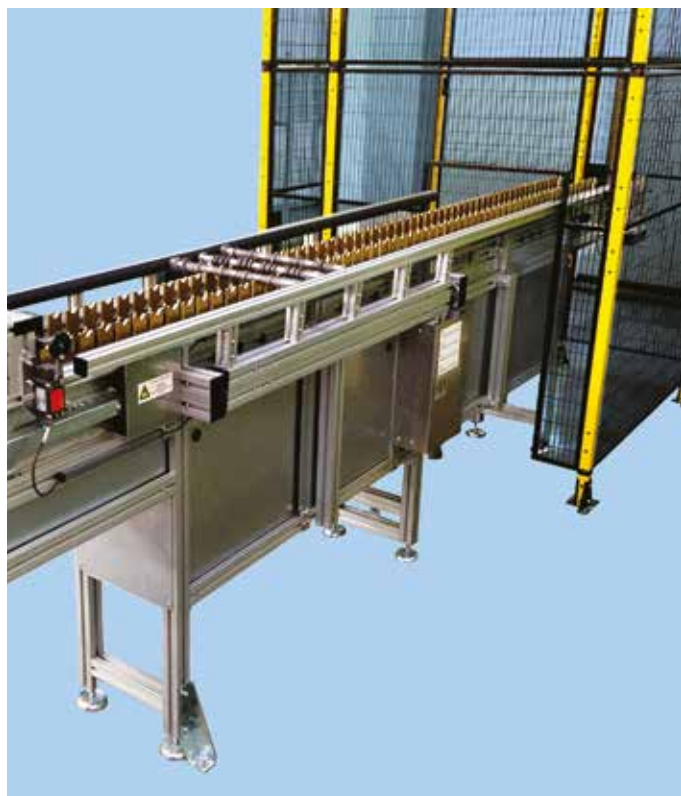
Sistema over-under di carico alberi a camme
