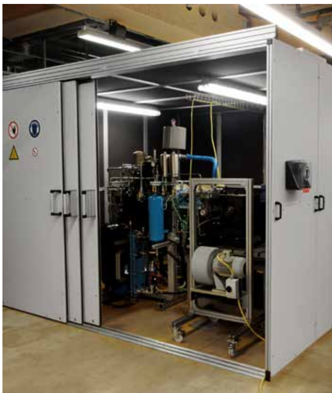
Cabina fonoassorbente per macchina operatrice (aperta e chiusa)
