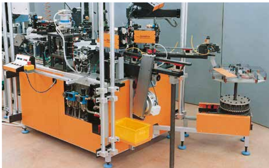
Guida per pannello di protezione su stazione automatica di assemblaggio con equilibratore del peso all'interno dei tubi in alluminio.
