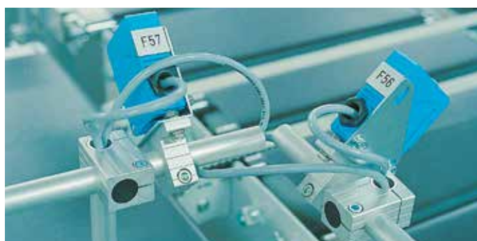
Fissaggio di fotocellule, facilmente regolabile.
