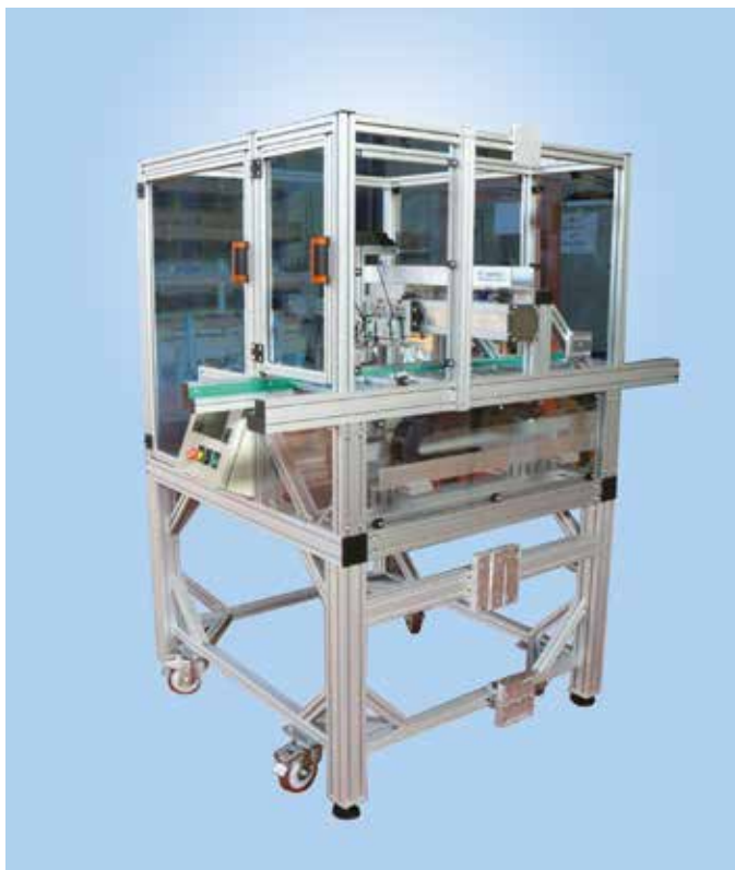
Telaio completo per apparecchiature di sinterizzazione
