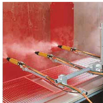
Sostegno dei nebulizzatori di impianto per rivestimento a polvere. Grazie al peso contenuto del sostegno si limitano le forze di accelerazione e decelerazione. Gli elementi hanno buone proprietà di conducibilità elettrica.
