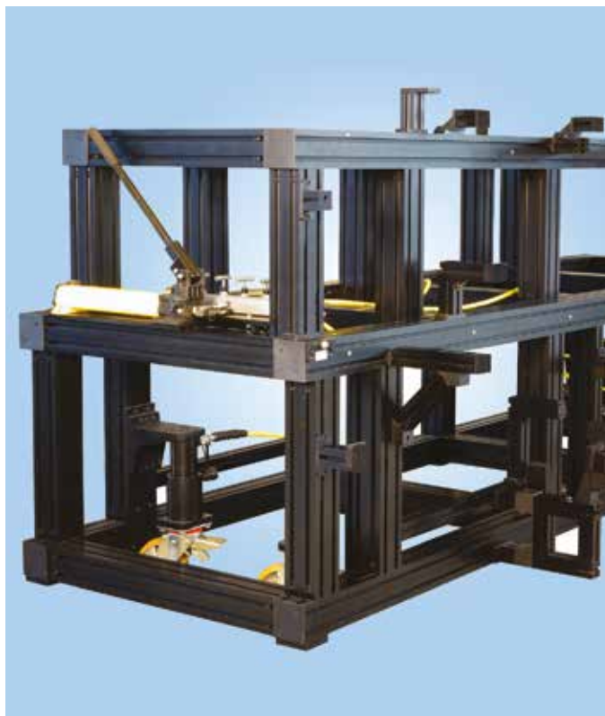
Struttura portante per Meisterbock di collaudo settore automotive
