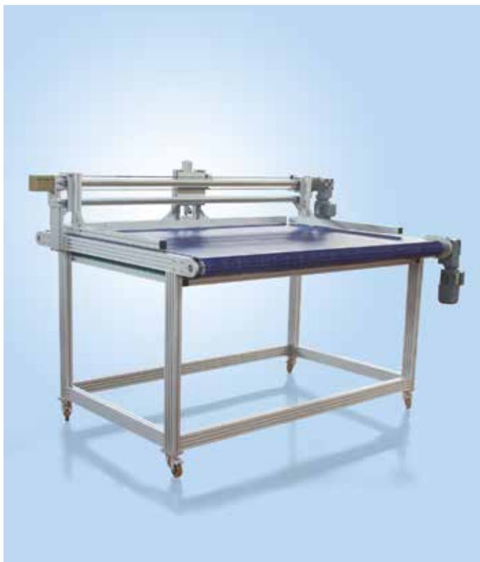
Nastro trasportatore con modulo lineare per cesoia
