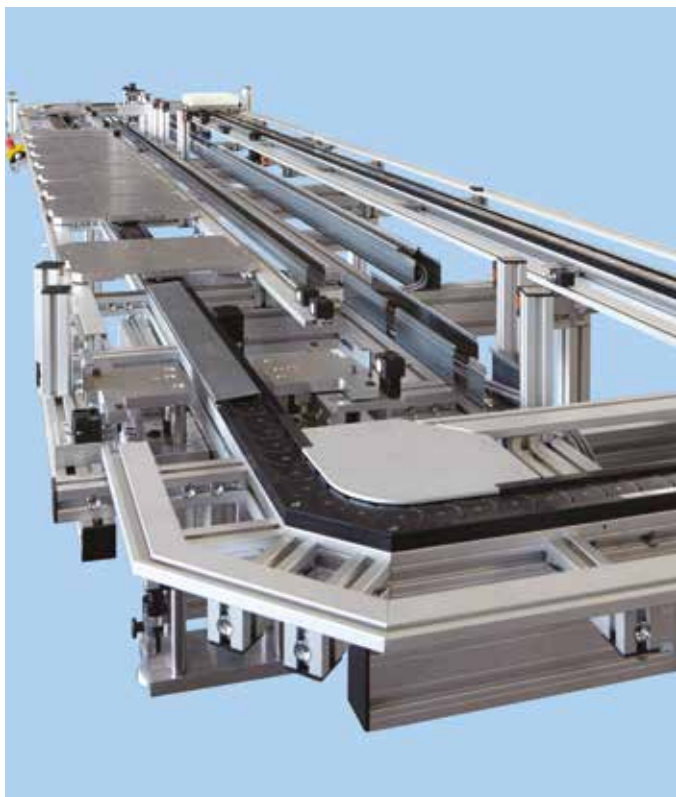
Sistema di carico componenti di tipo plate chain con pallet
