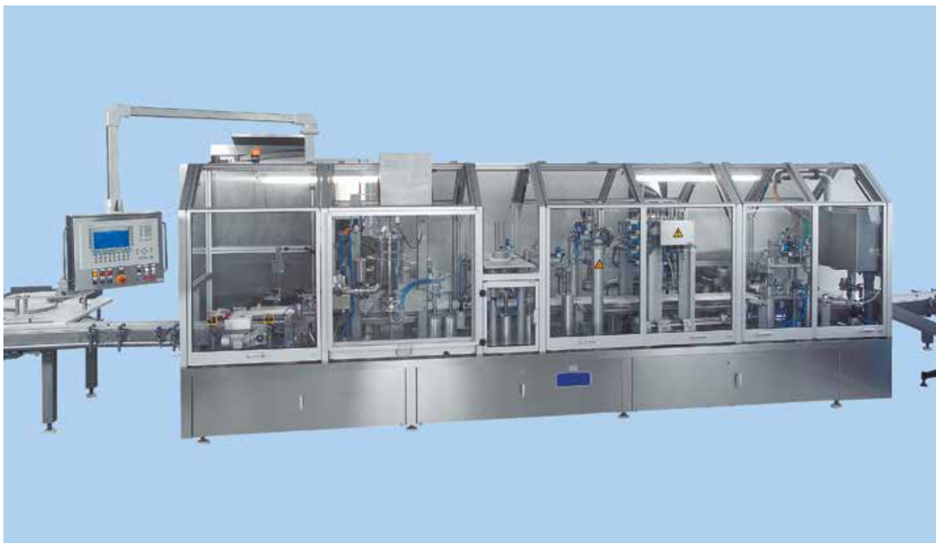
Impianto di imbottigliamento
