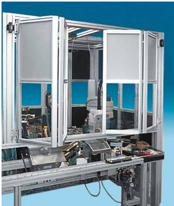
Protezione per impianto di imbottimento
