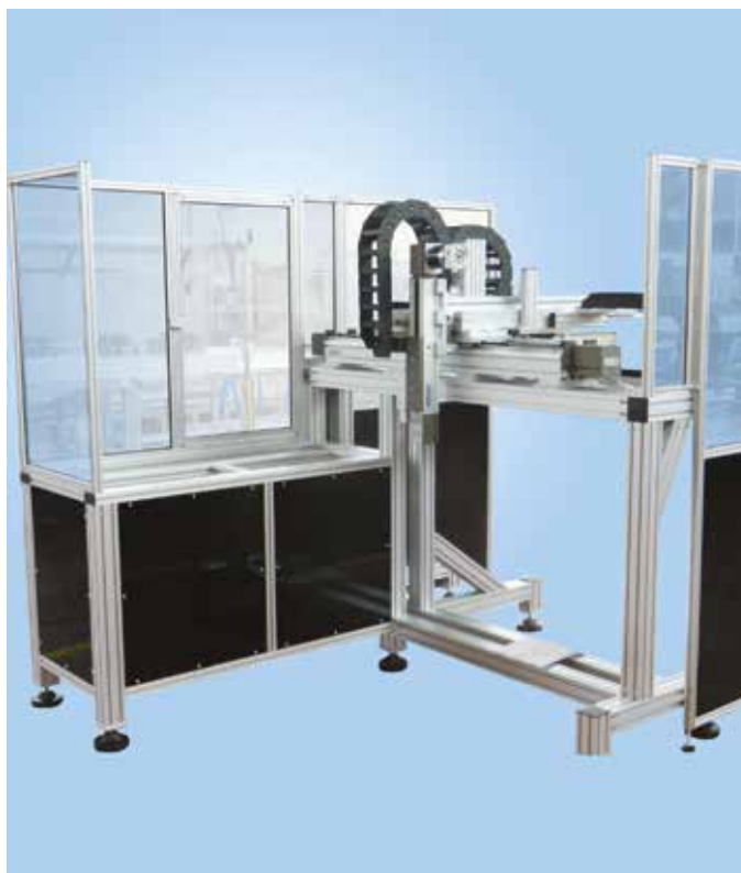
Struttura riparo con moduli lineari
