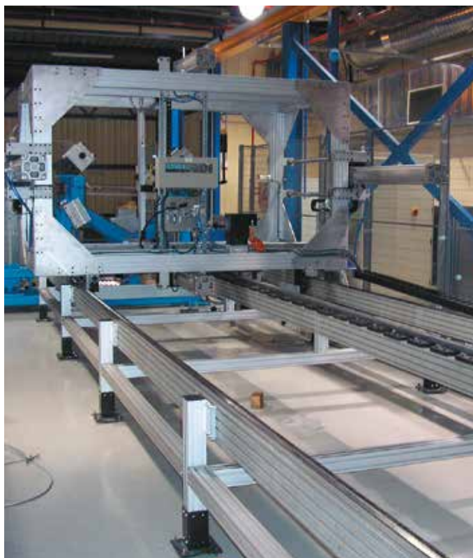
Telaio di macchina operatrice per lavorazioni di forature
