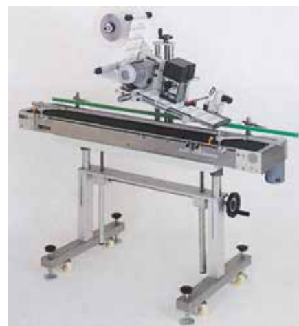
Etichettatrice con braccio orientabile per l'incollaggio.
