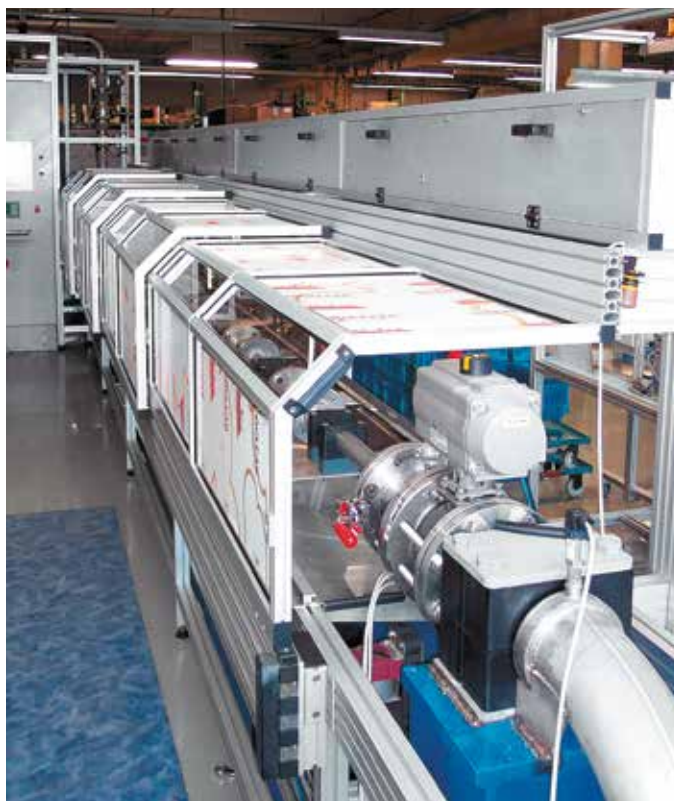
Copertura scorrevole telescopica a quattro elementi
