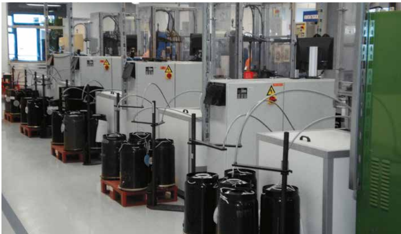
Rivestimento insonorizzante per macchina avvolgitrice
