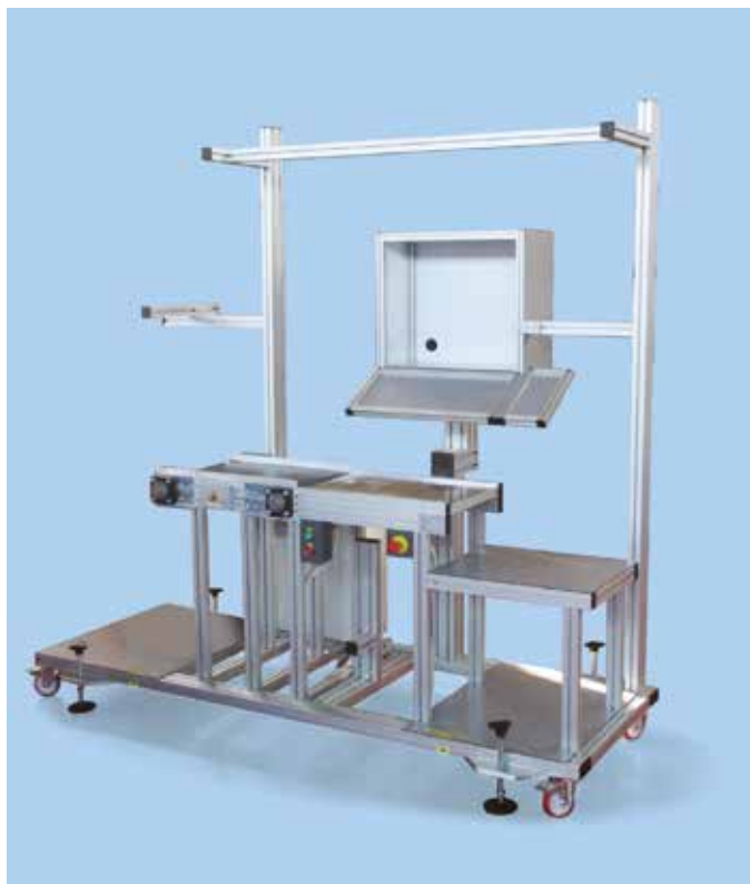
Nastro trasportatore integrato in banco di collaudo
