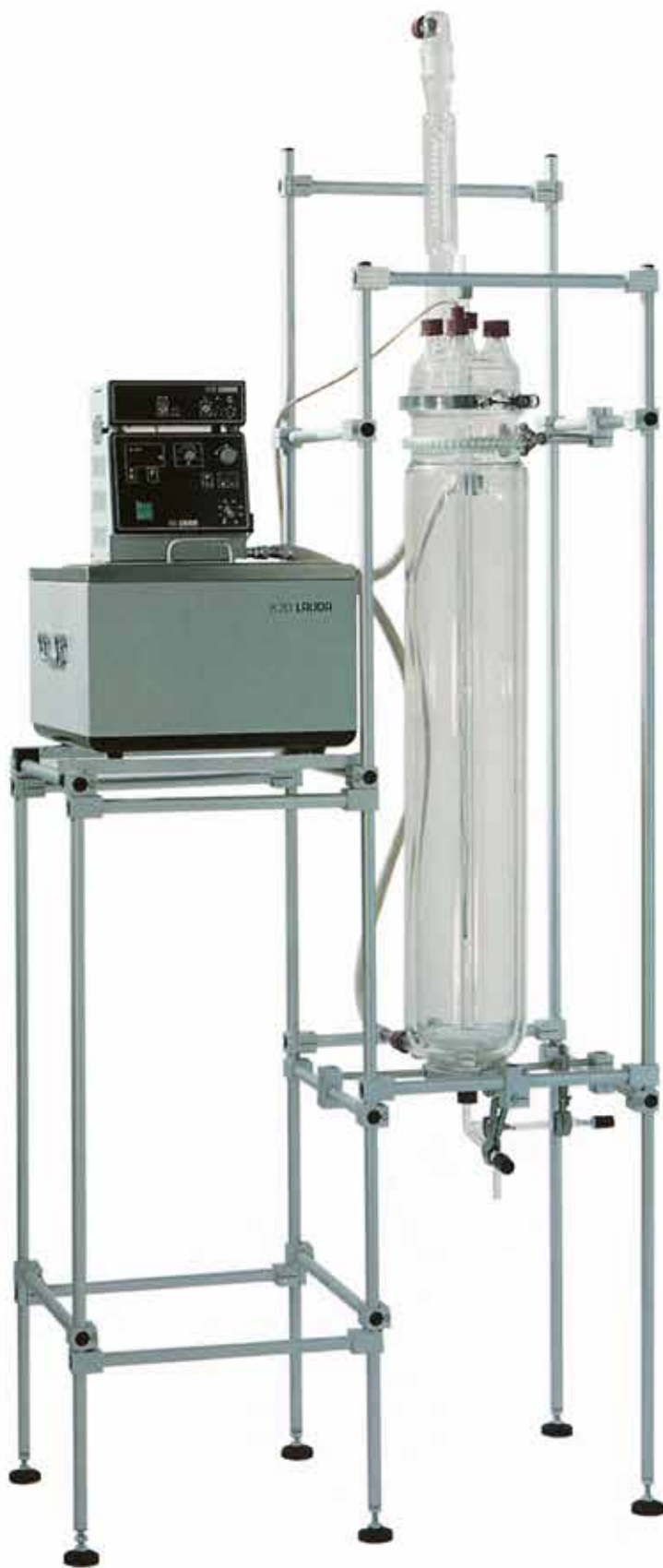
Reattore a colonna a bolle per fase liquida/gassosa con mantello di raffreddamento e sistema di iniezione gas.
