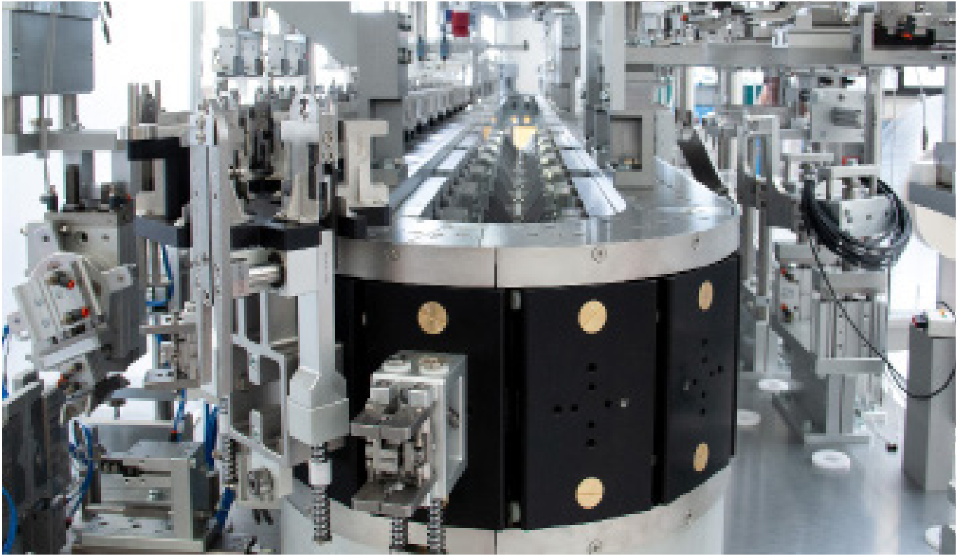
Precision Trak Conveyor 120 - Dettaglio di accumulo in curva
